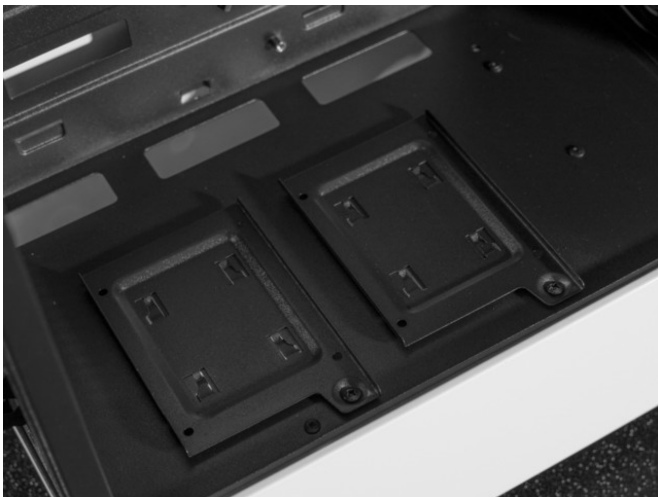
机箱内部 2.5 英寸硬盘架
