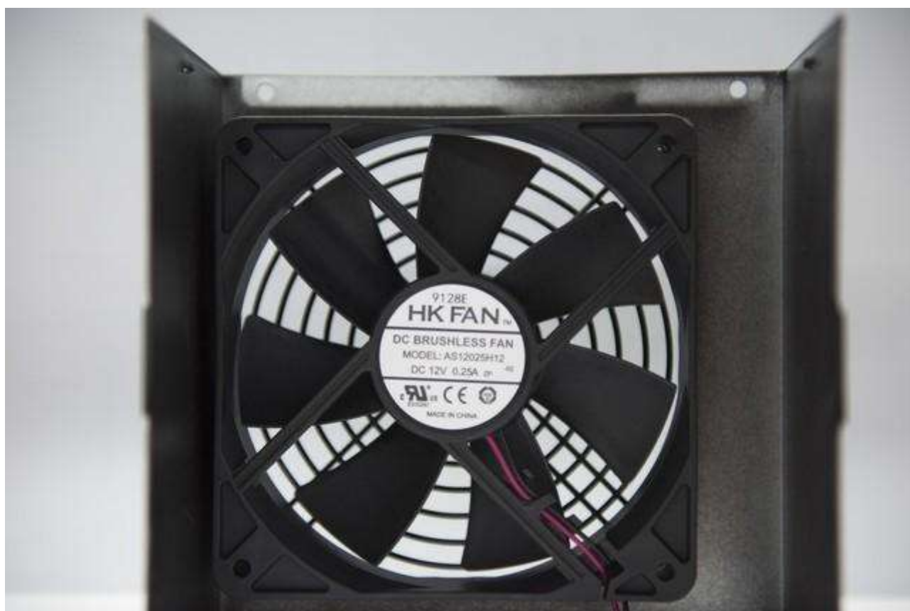
航嘉 12cm 電源液壓風扇搭配了溫控電路
